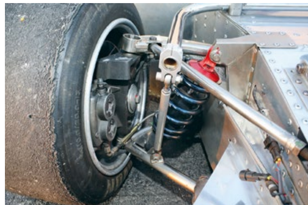
Train avant avec double triangulation, combiné ressort-amortisseur et barre anti-roulis.
