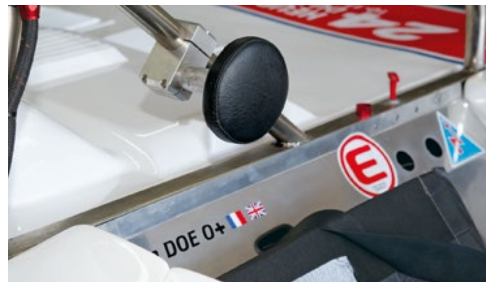
L'appui-tête faussement réglable en hauteur. Fixé sur un tube d'arceau oblique, toute variation de hauteur entraîne un déplacement latéral peu pratique.
