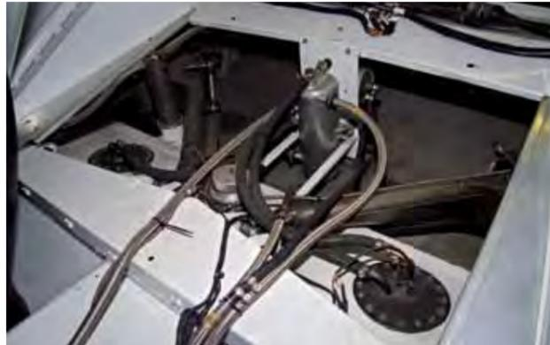
Une trappe amovible située à l'arrière du plancher permet d'accéder aux suspensions postérieures.
