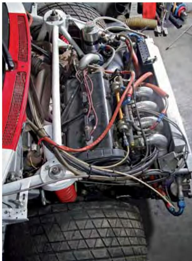
Vue plongeante sur le moteur 1600/16 soupapes. On remarque que l'implantation mécanique est considérablement plus aérée que sur la version 1360 dont les collecteurs d'admission et d'échappement sont inversés.
