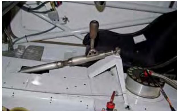
La boîte de vitesses est transversale, la présence de cet imposant tunnel de transmission s'explique par l'intention première de monter une transmission intégrale à laquelle il a fallu renoncer, faute de temps.
