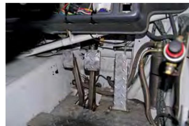
Un pédalier de monoplace, des vérins hydrauliques, un tunnel de transmission et pourtant c'est bien d'une AX qu'il s'agit.
