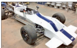
MARCH 1971 . Châssis N° 10, Ex Bev Bond. Moteur Ford Lotus 1600cc twin cam Colin Holt, refait (vilo, pistons, culasse). Passeport FIA de 1998 à refaire.
